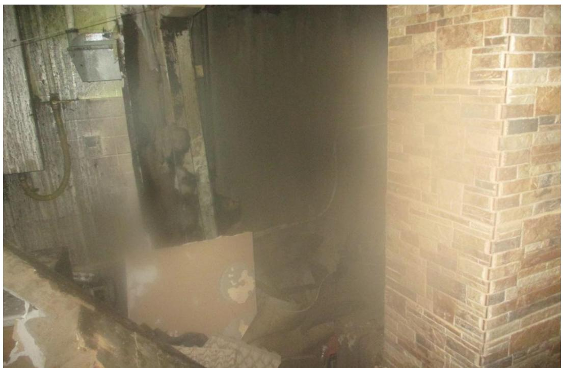
6). 06.02.2016 в помещении кухни (2х3 м) жилого дома (2-й пер. Маличевского, г. Жлобин, Гомельская обл.) произошел разрыв отопительного котла на твердом топливе. Хозяйка жилого дома была госпитализирована с ожогами 1-3 степени (20 % тела). Причина разрыва котла – отсутствие циркуляции воды в системе.
